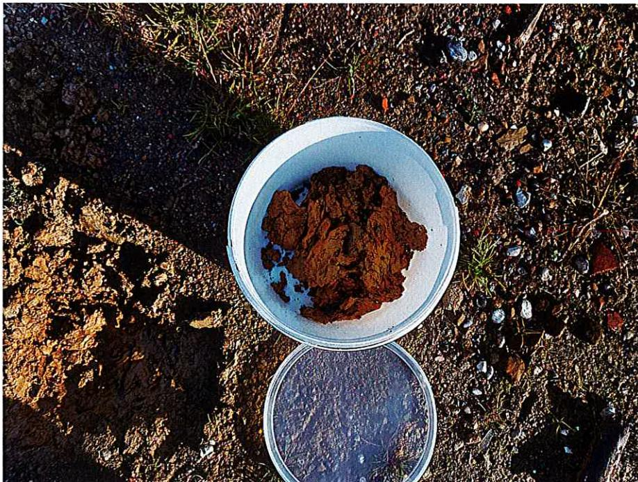
**Abbildung 4:** Sohlprobe SP 1 im Bereich des ehemaligen oberirdischen Tanks.
